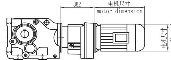
T..S157.. 无电机输入轴安装
